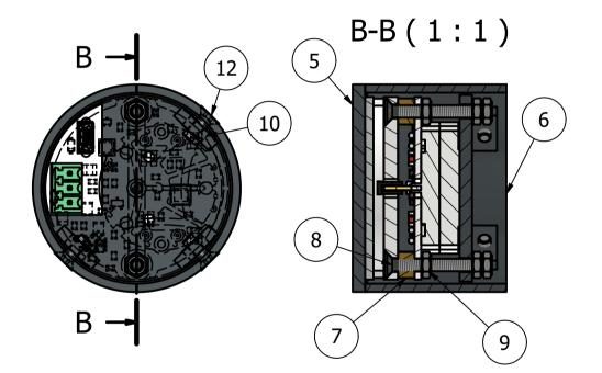
Tavola di assemblaggio tachimetro modello A - 4.0.A
