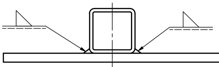
Prestare attenzione in fase di saldatura, dato il ridotto spessore del tubo
